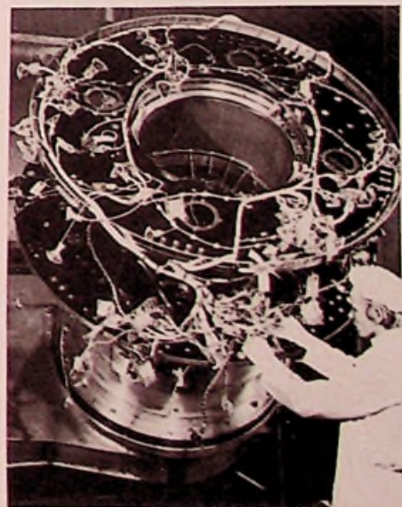
Afb. 2 GEOS, Europa's eerste geostationaire wetenschappelijke satelliet. Meer dan 2000 kabels met 280 connectoren zijn in dit ruimtevaartuig gebruikt, dat is ontworpen en gebouwd door het European Starconsortium van bedrijven onder contract van European Space Agency.
